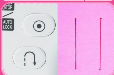
Fácil rematado, de inicio y fin de la costura. Hay dos tipos de remate, de atacado y el de refuerzo o condensación.
